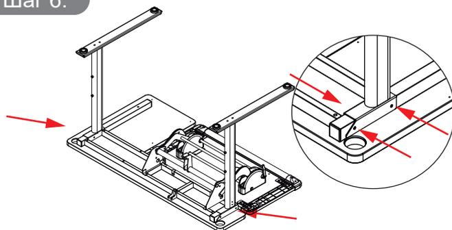
Используйте шестигранник (6) и винт (1) для фиксации опор (B) (C) к столешнице (A-1).
