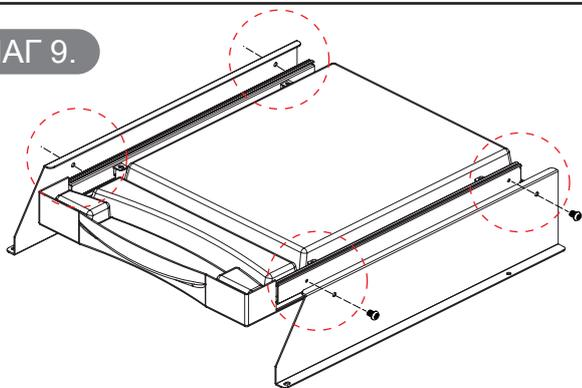
Используя отвертку (9) и винт (13) зафиксируйте ящик (L) к боковым металлическим частям стола
