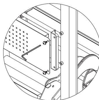
Закрепите резиновые подушечки (H) и заднюю панель (G) к обеим опорам (B) (C) при помощи винтов (2) и (6).
