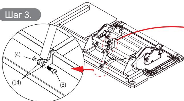
Закрепите у газ лифта винт (3) и контргайку (4) и пластиковую шайбу (14) к установке (D) и столешнице (A) (A-1) при помощи шестигранника и ключа (7) (8).
