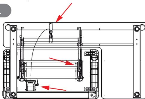
Соедините установку (D) со столешницей (A) (A-1) при помощи винта (1) и шестигранника (6). Соедините газ-лифт (F) и столешницу (A) при помощи винта (1) и шестигранника (6). Проследите чтобы провод газ-лифта проходил между столешницей и трубами установки.
