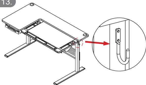
Закрепите крюки для сумок (I) к опорам (B) (C) винтами (10) и отверткой (9).
