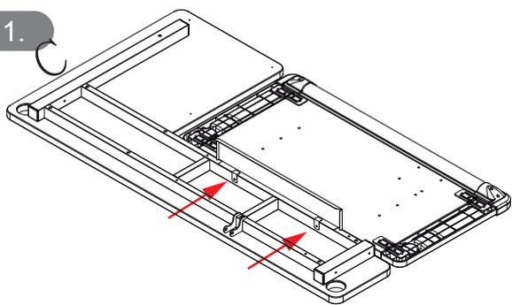
Переверните столешницы (A) (A-1) расположите параллельно, и используя инструмент (9) и винт (11) закрепите переднюю панель у стационарной столешницы (A-1).
