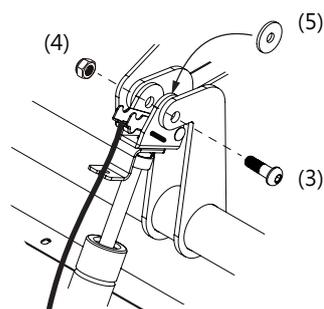
Винт (3) проходит через пластиковую шайбу (5) закрепляется при помощи контргайки (4).
