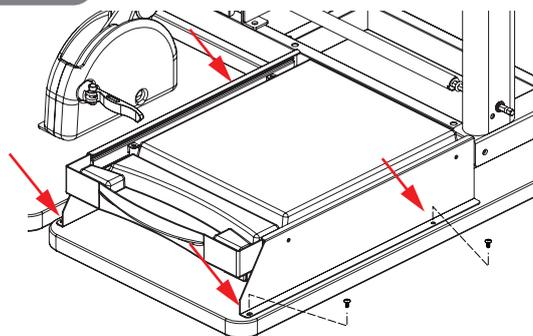
Используя отвертку (9) и винт (10) зафиксируйте ящик (L) к столешнице (A-1)
